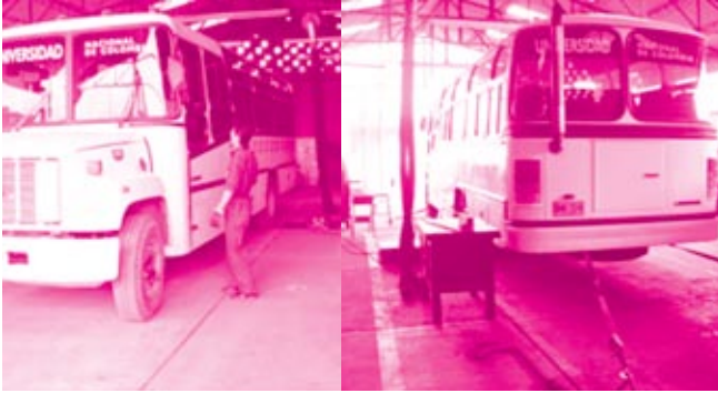
Foto 2 Vehículo de la Universidad Nacional de Colombia ubicado en el chasis dinamométrico del SENA
